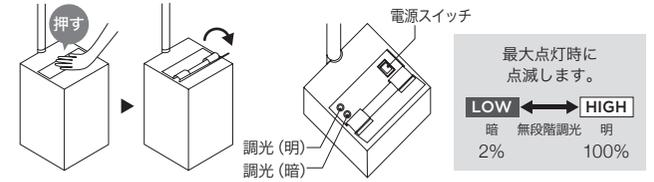
電源スイッチをONにすると点灯します。調光ボタンを押している間、明るさ(暗さ)レベルが変わり、離すと保持されます。電源をON/OFFしても明るさレベルは保持されます。バッテリー残量がわずかになると強制的に調光が下限値になり、調光操作ができなくなります。
